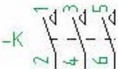
**Contactor.** Contactos principales del contactor. Es el encargado de realizar la conexión y desconexión del circuito en carga.
